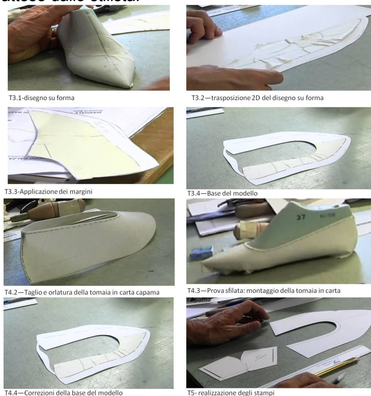
Fig. 3 - Alcune tra le operazioni maggiormente rilevanti nella realizzazione dell'attività (in particolare la realizzazione della prova sfilata T4.2 e T4.3)
